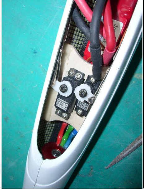
3. Regler (z.B. Kontronik Jazz 80-6-18) unten auf dem Rumpfboden, Seiten- und Höhenruder-Servo installieren (lt. Foto).
