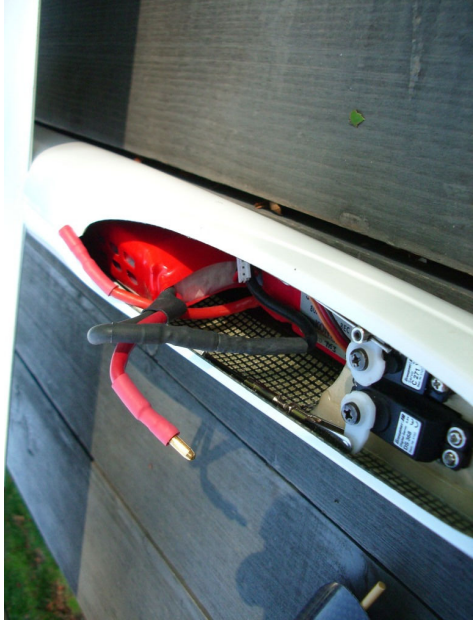
4. Akkupack: es gibt ausreichend Platz für 3S-Lipo bis 4000 mAh. Wir empfehlen 3300 oder 3700 mAh Flightpower EVO 3S-Lipos zu verwenden. Die Abbildung zeigt Xcell 3900 mAh 3S-Lipo Pack.
